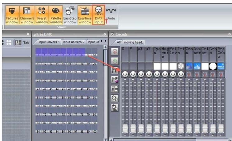
DMX 入力チャンネルは、ボタンエディタの範囲内でフィクスチャーチャンネルに直接割り当てることもできます。DMX 入力パネルを開くため、(1) をクリックしてください。そして、フィクスチャーチャンネル上に希望の DMX 入力チャンネルをドラッグしてください。
