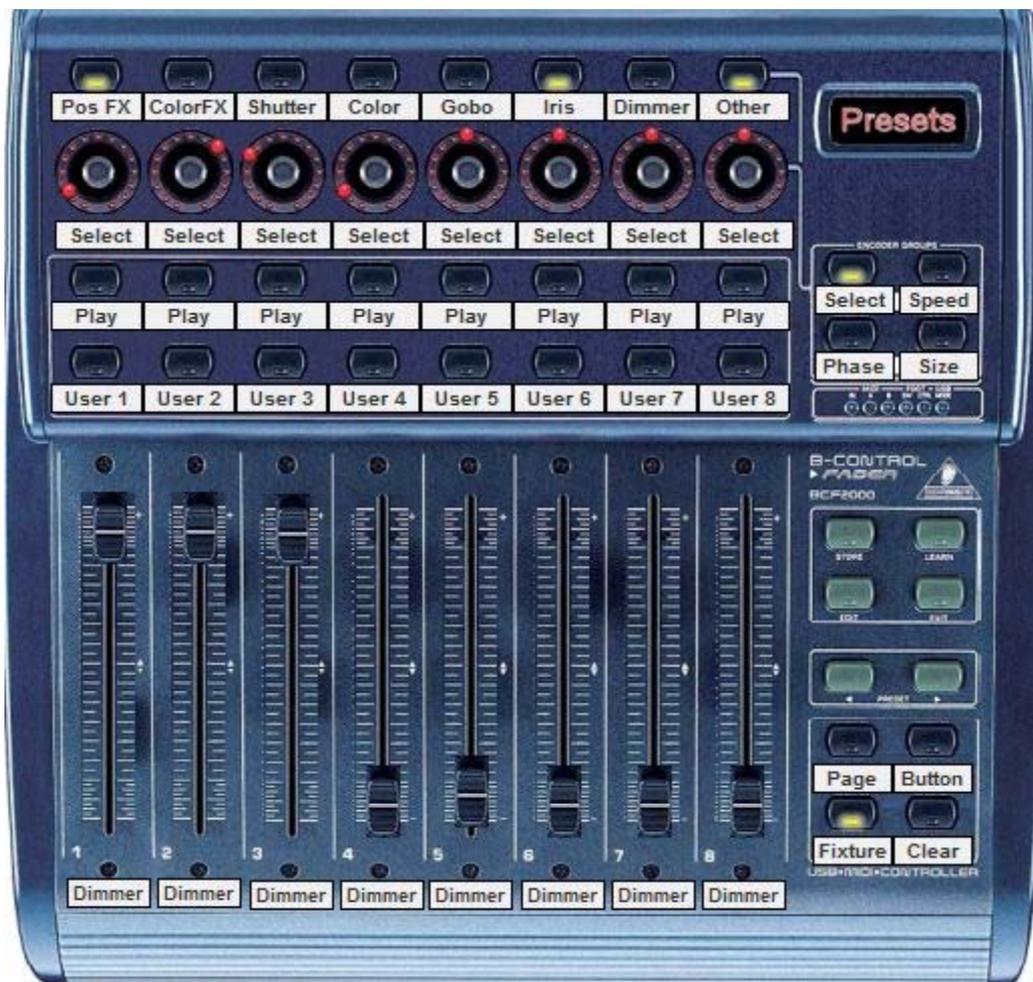
Behringer BCF2000 のデフォルトマッピングは、コンソールの右下でボタンを使って選ぶことができる 3 つのモードを特徴としています。
