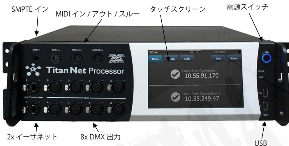
TitanNet Processorは、コントロールサーフェスの無いコンソールです。ショーのDMXラインは、コンソールの処理を別ユニットにオフロードすることで16を超えて拡張できます。
