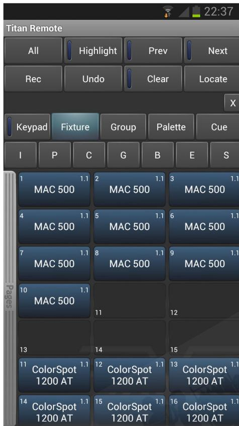
次に、パレット画面を使用してフィクスチャーを制御したり、IPCGBES ボタンを押してホイールを使用してフィクスチャーの機能を直接制御したりできます。
