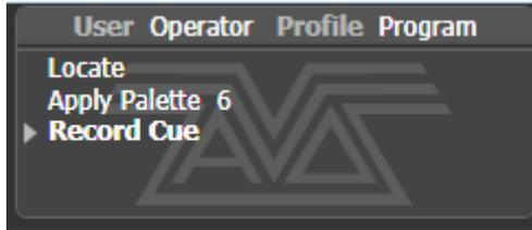
コントロールホイールの上画面では、ホイールの現在の機能が、シミュレートされたローラーに表示されます。フィクスチャーアトリビュートが設定されている場合、これはフィクスチャーで利用可能なセッティングを表示します。ローラー画像の上部に、それぞれのホイールで制御されているアトリビュートがレジェンドに表示され、ローラーの中心に現在のアトリビュートが表示されます。ローラーの上部または下部のセグメントをタッチして、アトリビュートを最大/最小に設定します。
