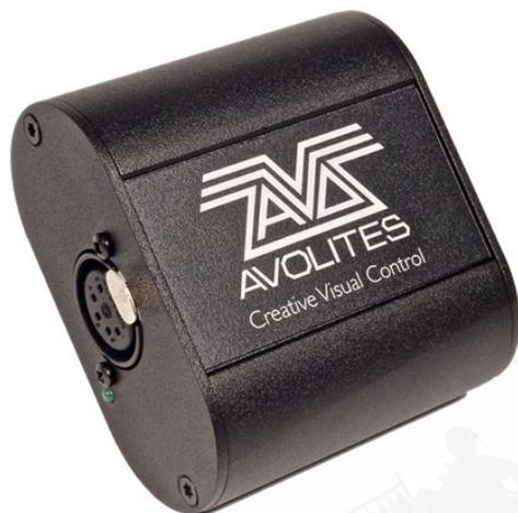
T2 は、2 つの 5 pin XLR で 2 つのユニバースを提供し、外部トリガー用のオーディオ / LTC タイムコードの入力を備えています。また、Titan の MIDI トリガー用の USB MIDI デバイスを使用できるため、MIDI フェーダーを使用でき、Titan Mobile フェーダーウィングで使用できます。
